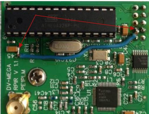
Una vez hecho el puente, recolocaremos correctamente la placa DVmega en la Raspberry y la encenderemos. Todo funcionará con normalidad y a partir de hoy el puente se quedará para siempre instalado en la placa.
